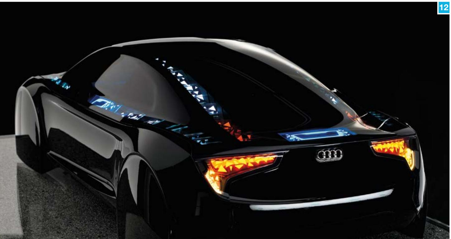
Audi hat auf der Elektronikmesse CES in Las Vegas das neue OLED-Beleuchtungskonzept „Organic Light Emitting Diode“ am Heck des Audi R8 vorgestellt. Es unterscheidet sich von herkömmlichen LEDs dadurch, dass es nicht aus Halbleiter-Kristallen besteht, sondern aus organischen Polymeren.
