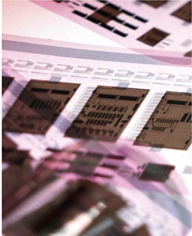
Für ihren Einsatz als gedruckte Elektronik müssen Polymere sehr homogen in mehreren Lagen auf flexible Träger gedruckt werden. Damit lassen sich dann unter anderem auch sogenannte Radio-Frequenz-Identifikations-Transponder (RFID) herstellen, die Informationen berührungslos übertragen können (rechts).
