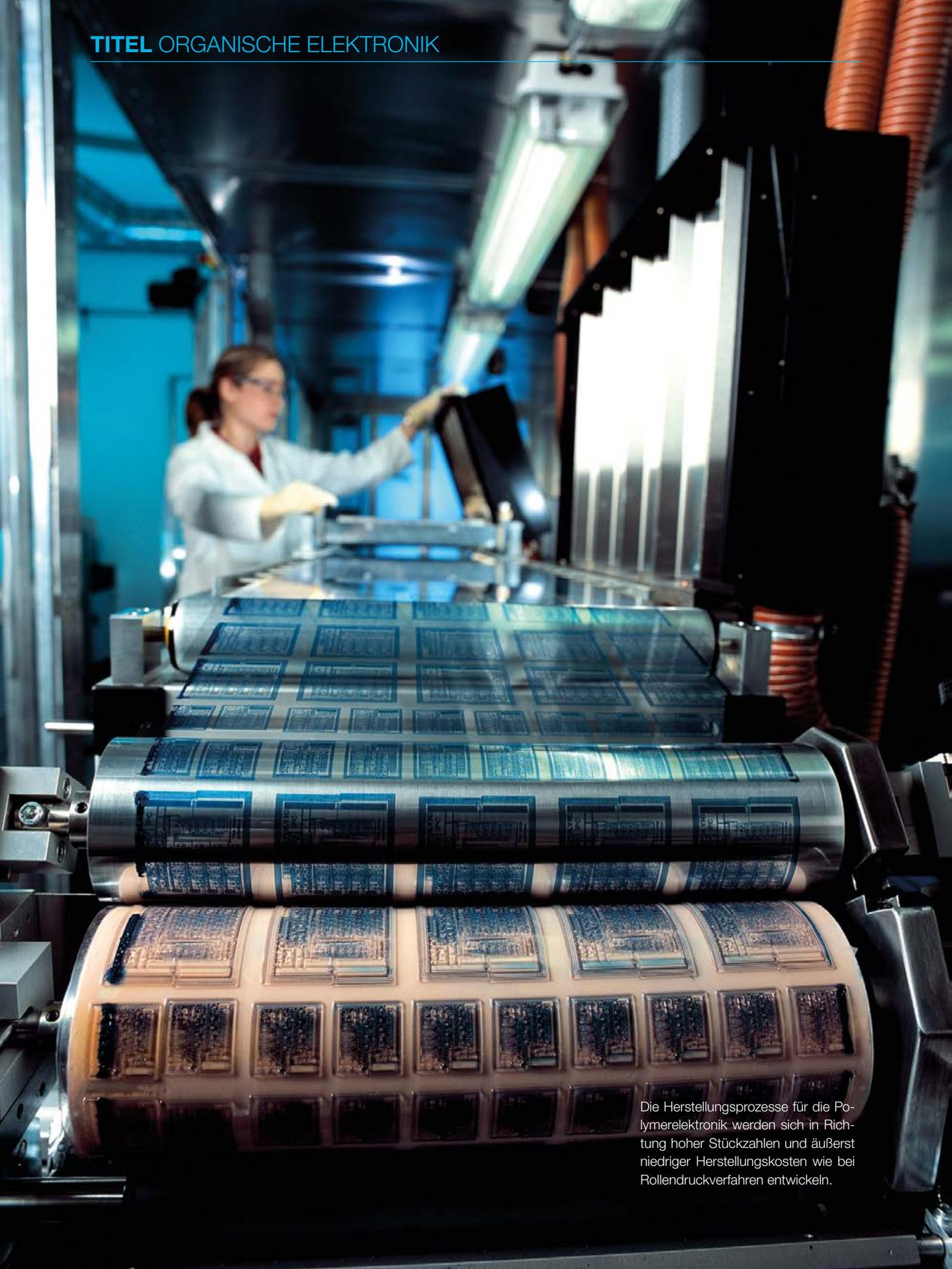
Die Herstellungsprozesse für die Polymerelektronik werden sich in Richtung hoher Stückzahlen und äußerst niedriger Herstellungskosten wie bei Rollendruckverfahren entwickeln.
